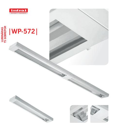
Lâmpada Fluorescente Tubular T5. Corpo em chapa de aço tratada e pintada. Refletor facetado em alumínio anodizado brilhante de alta refletância e alta pureza 99,85%. Difusor em poliestireno plano transparente. Soquete tipo push-in G-5 de engate rápido, rotor de segurança em policarbonato e contatos em bronze fosforoso. Instalação em perfilado.
