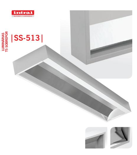
Lâmpada Fluorescente Tubular T5. Corpo em chapa de aço tratada e pintada. Refletor facetado em alumínio anodizado brilhante de alta refletância e alta pureza 99,85%. Soquete tipo push-in G-5 de engate rápido, rotor de segurança em policarbonato e contatos em bronze fosforoso. Instalação de sobrepor.
